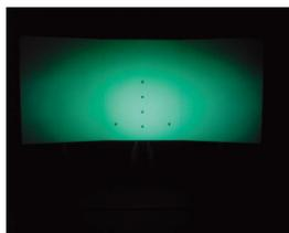
滑走路に設置されている灯器の照度分布を測定・検査
